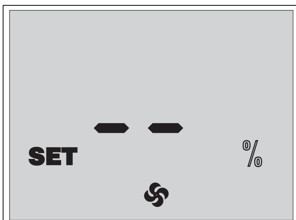
Рис. 11. Настройка скорости вентиляторов
