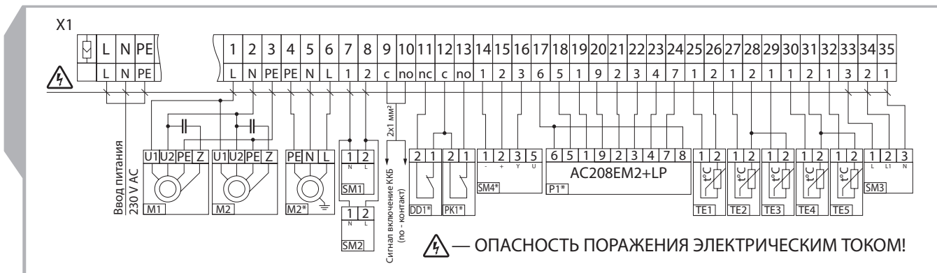
Рис. 17. Схема внешних подключений ВУТ 800 (1000) ВГ
