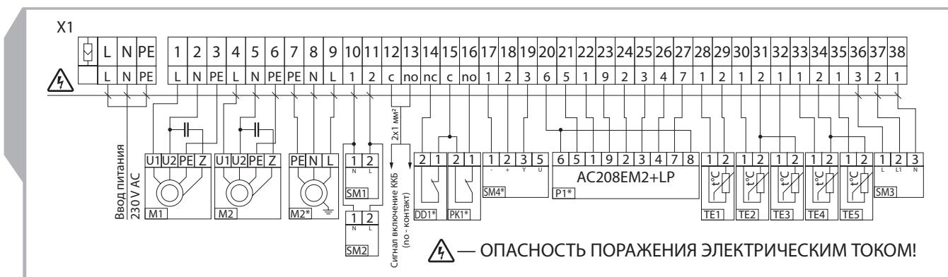
Рис. 18. Схема внешних подключений ВУТ 1500 (2000) ВГ
