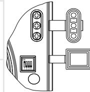
Вибір режиму роботи здійснюється встановленням DIP-перемикача у певне положення. Використайте пластикову викрутку, яка входить до комплекту постачання вентилятора для перемикання положення DIP-перемикача.
