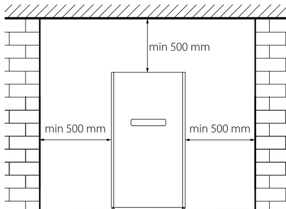
До комплекту постачання входить шаблон для розмічування отворів. Закріпіть шаблон на стіні на необхідному рівні. Нанесіть позначки під отвори для повітропроводів, отвори для кріплення установки та місця виходу кабелю живлення. Для початку монтажних робіт прокладіть необхідні дроти та кабелі до місця кріплення установки.
