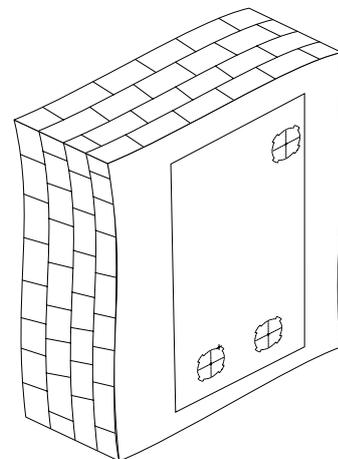
Зніміть шаблон та просвердліть у стіні два наскрізних отвори  $\varnothing$  120 мм для круглих повітропроводів. У разі монтажу установки з витяжним патрубком підготуйте нішу в стіні для з'єднувального коліна та прокладання прямокутного повітропроводу.
