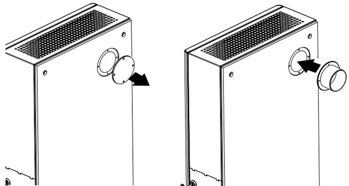
Відкрийте установку. Відкрутіть гвинти та зніміть захисну панель для доступу до монтажних отворів.
