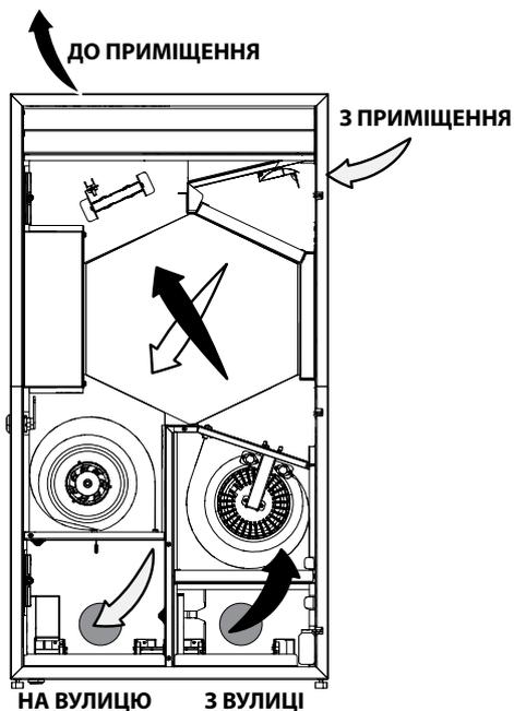
Тепле забруднене повітря з приміщення потрапляє до установки, де очищується за допомогою витяжного фільтра, далі повітря проходить через рекуператор і за допомогою витяжного вентилятора повітропроводом видаляється назовні.
