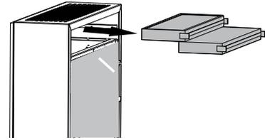
Якщо встановлено витяжний патрубок, зніміть верхню захисну панель та встановіть магнітну заглушку на витяжну решітку. Під час знімання панелі від'єднайте кабель заземлення.
