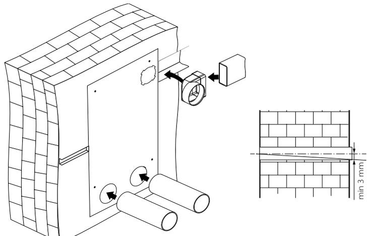
Для встановлення витяжного патрубка необхідно демонтувати заглушку на тильному боці установки.
