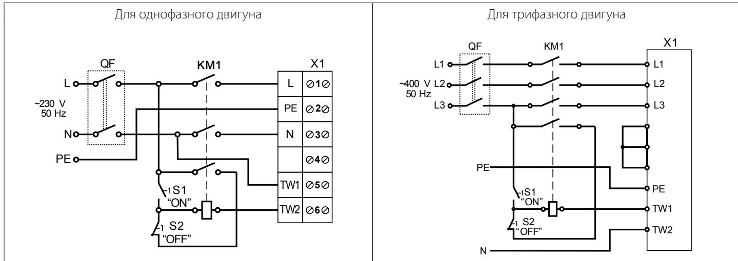
Клеми TW1, TW2 є виведеннями нормально замкненого контакту термозахисту двигуна.
