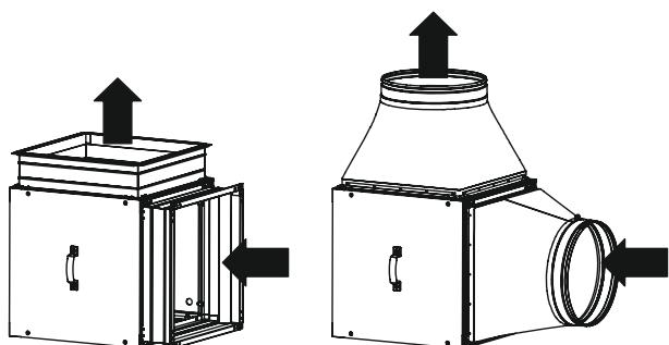
Приєднувальні патрубки, які водночас виконують функцію віброгасильних вставок, можуть бути квадратного або круглого перерізу. Патрубки круглого перерізу оснащені гумовими ущільнювачами.
