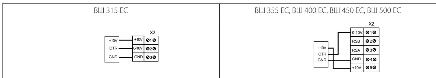
Керування вентилятором за допомогою датчика вуглекислого газу (рекомендуються датчики CO2-1, CO2-2) може проводитися як з аналогового виходу пристрою (0-10 В), так і з дискретного виходу (контакт реле).
