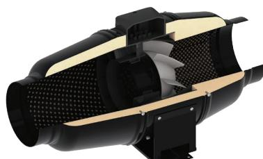
Завдяки конічній формі крильчатки та спеціально спрофільованим лопатям кругова швидкість повітряного потоку збільшується, забезпечуючи вищий тиск та продуктивність порівняно зі звичайними осьовими вентиляторами.
