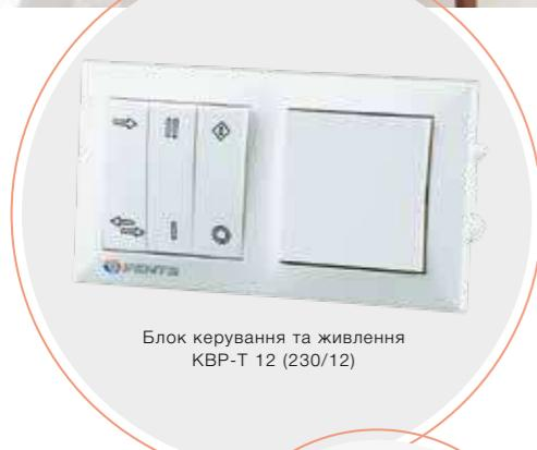
Керування провітрювачами здійснюється за допомогою панелі керування КВР або блоку керування та живлення КВР-Т 12 (230/12). Блок керування та живлення КВР-Т 12 (230/12) потужністю 12 Вт входить до складу ТвінФреш РА-50 та об'єднує в одному корпусі панель керування КВР і трансформатор ТРФ 220/12-12.
