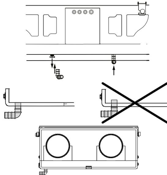
Розташування дренажних отворів під час монтажу за сх. 2
