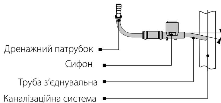
Система відведення конденсату призначена для експлуатації у приміщеннях із температурою вище 0 °С! Якщо температура нижче 0 °С, система відведення конденсату має бути теплоізольована та обладнана підігріванням. Для модифікації ВУЕ 180 П5(Б) відведення конденсату не потребується.
