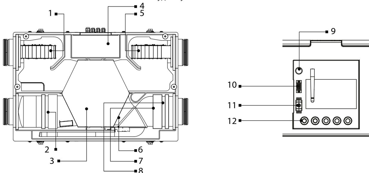
1 — припливний вентилятор, 2 — витяжний фільтр G4, 3 — рекуператор, 4 — блок керування, 5 — витяжний вентилятор, 6 — байпасна заслінка (для моделей ВУТ/ВУЕ 180 П5Б ЕС), 7 — припливний фільтр F7, 8 — припливний фільтр G4, 9 — кнопка SETUP MODE (для моделей ВУТ/ВУЕ 180 П5Б ЕС А21), 10 — роз'єм підключення каналного нагрівача попереднього нагрівання (для моделей ВУТ/ВУЕ 180 П5Б ЕС А21), 11 — роз'єм підключення каналного нагрівача догрівання (для моделей ВУТ/ВУЕ 180 П5Б ЕС А21), 12 — гермовводи.
