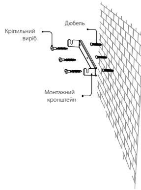
Кріпильні вироби для монтажу установки не входять до комплекту постачання, замовляються окремо.
