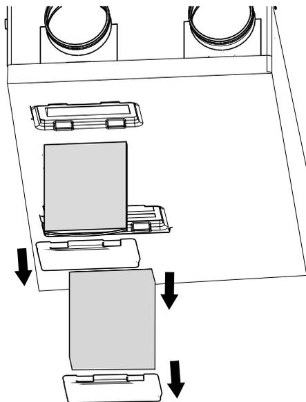
Для очищення або заміни фільтрів від'єднайте знімні пластини, розташовані на боці обслуговування установки. Після очищення встановіть фільтри та знімні пластини у зворотному порядку.
