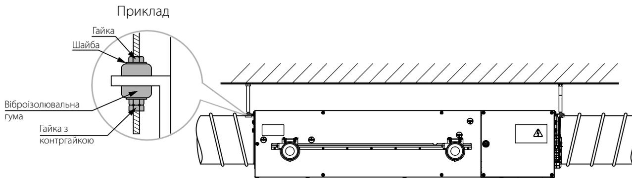
Для забезпечення найбільш ефективної продуктивності установки та зменшення аеродинамічних втрат, пов'язаних із турбулентністю потоку повітря, рекомендується на вході та виході із установки встановити прямий відрізок повітропроводу.
