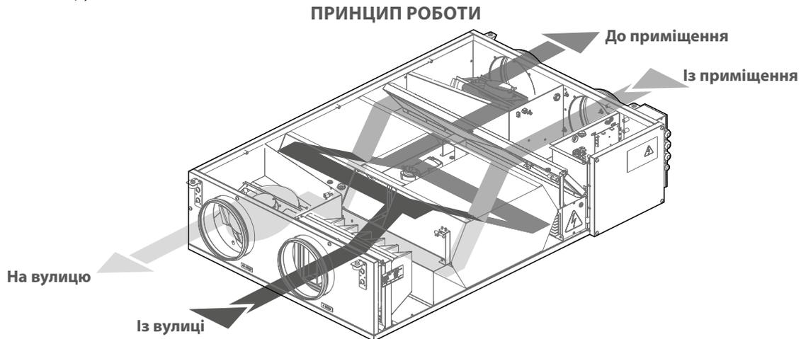
До конструкції установки входять припливний та витяжний відцентрові вентилятори однобічного всмоктування із загнутими вперед лопатками робочого колеса і ЕС-двигунами, які не потребують технічного обслуговування, із зовнішнім ротором та вбудованим тепловим захистом, пластинчастий протипотоковий рекуператор та електричний нагрівач.
