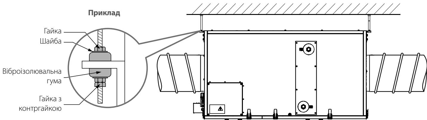
Для забезпечення найкращої продуктивності установки та зменшення аеродинамічних втрат, пов'язаних з турбулентністю повітряного потоку, рекомендовано на вході та виході з установки встановити пряму ділянку повітропроводу.
