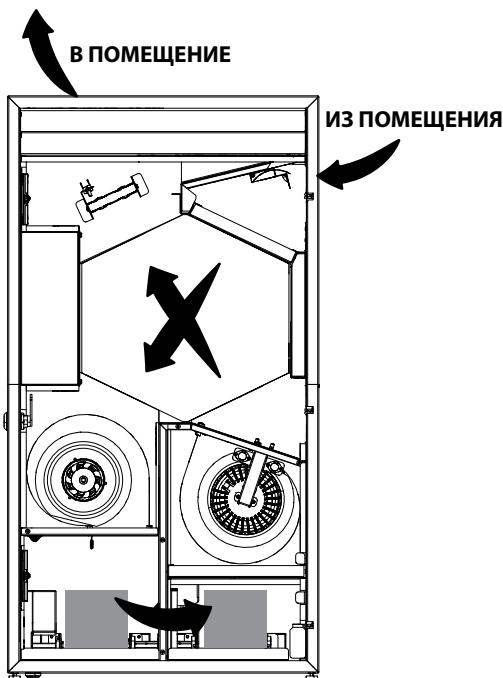
Установка оборудована рециркуляционной заслонкой. В режиме рециркуляции она открыта, а приточная и вытяжная заслонки закрыты. Воздух из помещения проходит через фильтры, повторно очищается и через рекуператор подается обратно в помещение.
