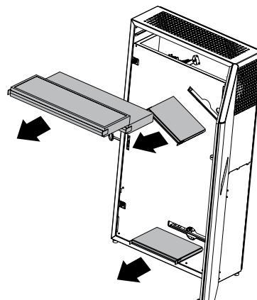
**2. Техническое обслуживание рекуператора (1 раз в год).**
