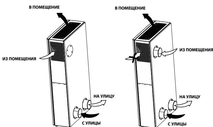
В установке предусмотрен монтаж вытяжного патрубка ( $\varnothing 100$  мм) для обслуживания другого помещения, например, ванной комнаты. Патрубок входит в комплект поставки. Вытяжная решетка должна быть закрыта магнитной заглушкой, входящей в комплект поставки (см. раздел "Монтаж и подготовка к работе").
