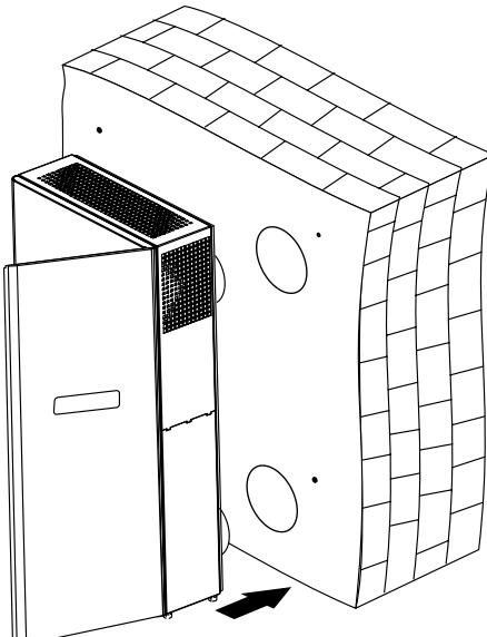
Поднимите установку, вставьте патрубки в соответствующие установленные в стене воздуховоды. Наклон воздуховодов должен быть минимум 3 мм.
