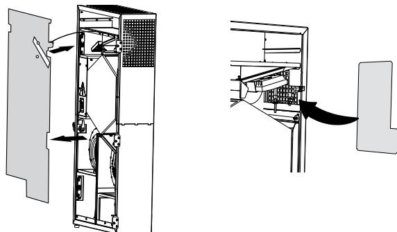
Если установлен вытяжной патрубок, снимите верхнюю защитную панель и установите магнитную заглушку на вытяжную решетку.
