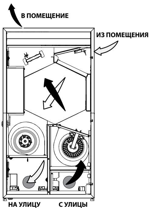
Теплый загрязненный воздух из помещения поступает в установку, где очищается с помощью вытяжного фильтра, далее воздух проходит через рекуператор и с помощью вытяжного вентилятора по воздуховоду удаляется на улицу. Чистый холодный воздух с улицы по воздуховодам поступает в установку, где очищается с помощью приточного фильтра, далее проходит через рекуператор, подогревается за счет тепла вытяжного воздуха и с помощью приточного вентилятора подается в помещение.
