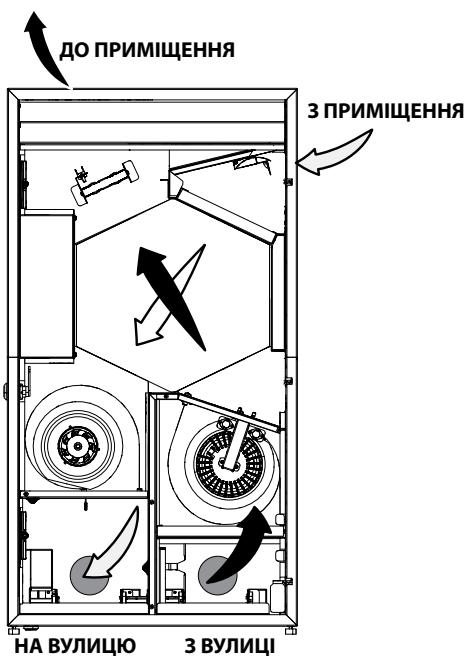
Тепле забруднене повітря з приміщення потрапляє до установки, де очищується за допомогою витяжного фільтра, далі повітря проходить через рекуператор і за допомогою витяжного вентилятора повітропроводом видаляється назовні.
