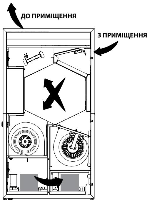
Установка обладнана рециркуляційною заслінкою. У режимі рециркуляції вона відкрита, а припливна та витяжна заслінки закриті.
